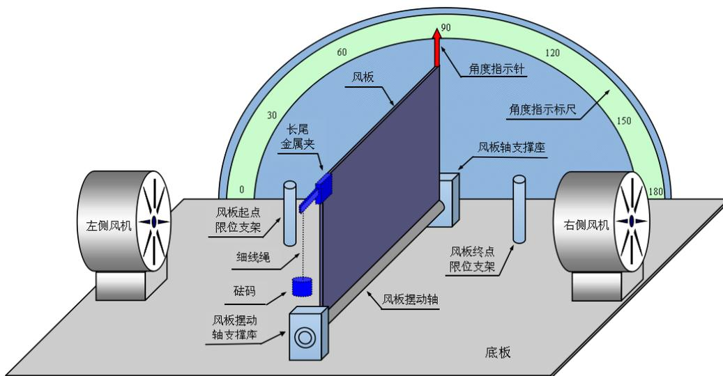
图1 风板控制装置参考示意图
