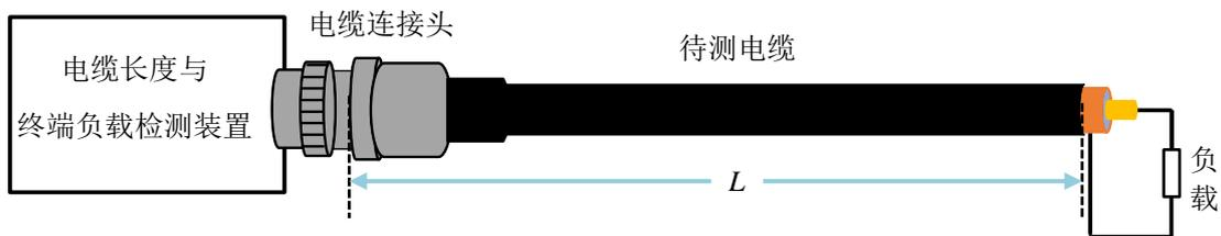
图 1 同轴电缆长度及终端负载检测装置示意图
